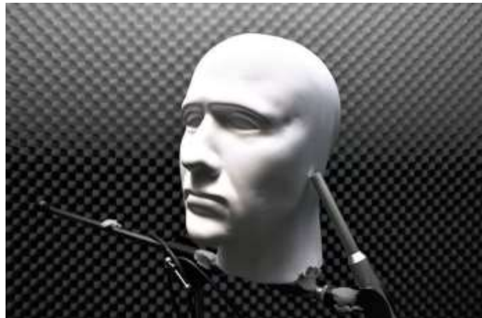
Figura 3 – Modelo de cabeça humana usada para gravações binaurais
